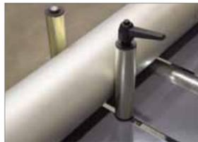
Dispositif de mise à niveau
